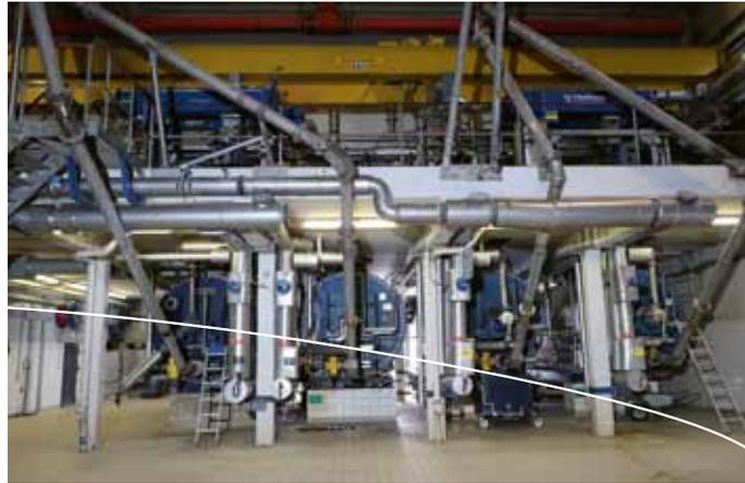
Schilfers (Vorstufe von Tiermehl) beträgt ca. 11–14 %. Im Trubabscheider wird der Großschmutz (Trub) abgeschieden. Das vorgereinigte Fett wird anschließend zu einem Dekanter zur Feinreinigung gepumpt. Das Reinfett gelangt danach mittels Pumpen zum Zwischenspeichertank
